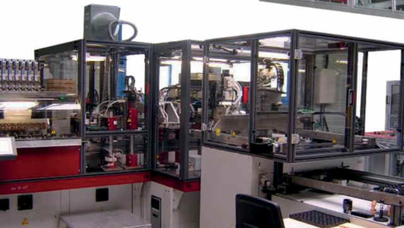
Ligne de marquage de boucles d'identification pour animaux.
